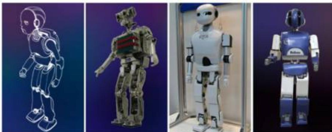
過去のデータからリンクの寸法、質量の設定、減速機の減速比の設定、モータの選定、その結果から質量の修正、減速比の調整を全関節くり返す。
